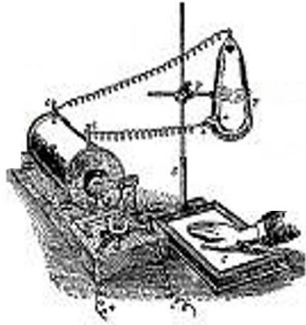
レントゲン装置の概念図
